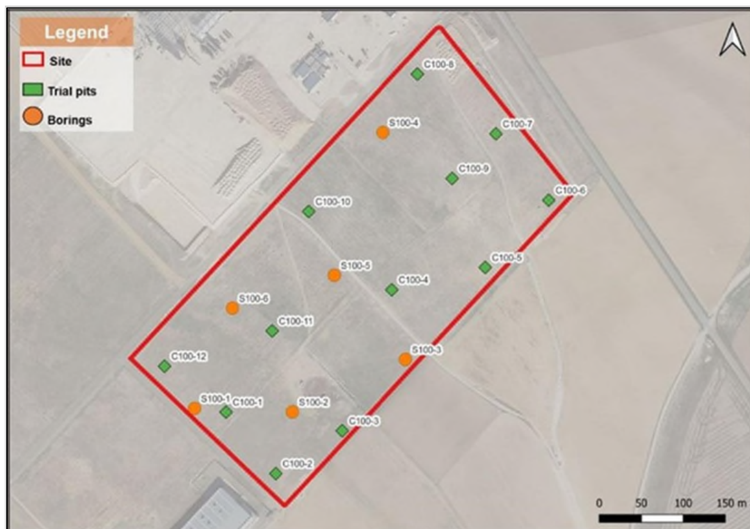
Figura 7. Localización de las calicatas y de los sondeos instalados (emplazamiento ZAZ100)
